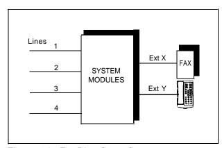
Figure 4-6. Fax Line Saver Setup
