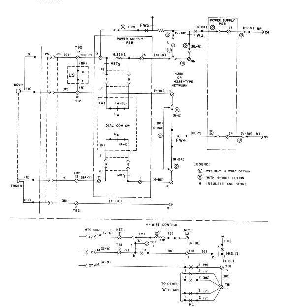
Fig. 13—2872A1M (MD) or 2872A2M Telephone Set—2/4-Wire Connections
