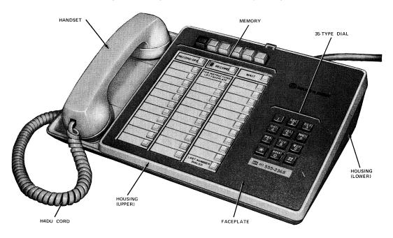
Fig. 1—2872A1M (MD) or 2872A2M Telephone Set
