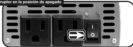
Interruptor en la posición de apagado
