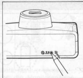
Nach der letzten Aufnahme wird der Film automatisch zurückgespult. Nach vollständiger Rückspulung blinkt das Filmsymbol und der Motor stoppt. Bitte den Film herausnehmen. Möchten Sie einen Film, der noch nicht ganz belichtet ist, vorher zurückspulen, dann drücken Sie den manuellen Rückspulknopf an der Unterseite der Kamera.
