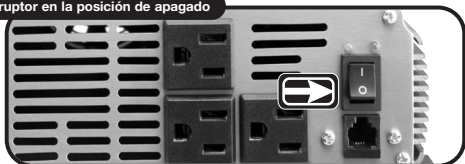
Interruptor en la posición de apagado
