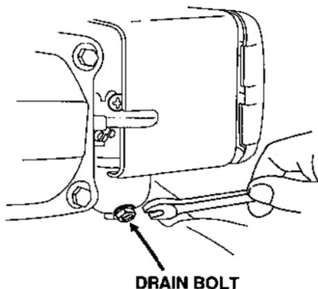
3. Reinstall the drain bolt.
