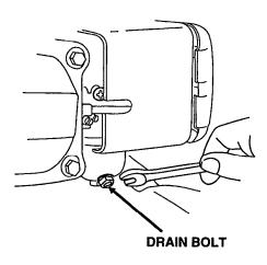
3. Reinstall the drain bolt.
