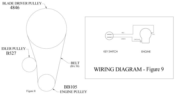
ENGINE PULLEY CONFIGURATION
