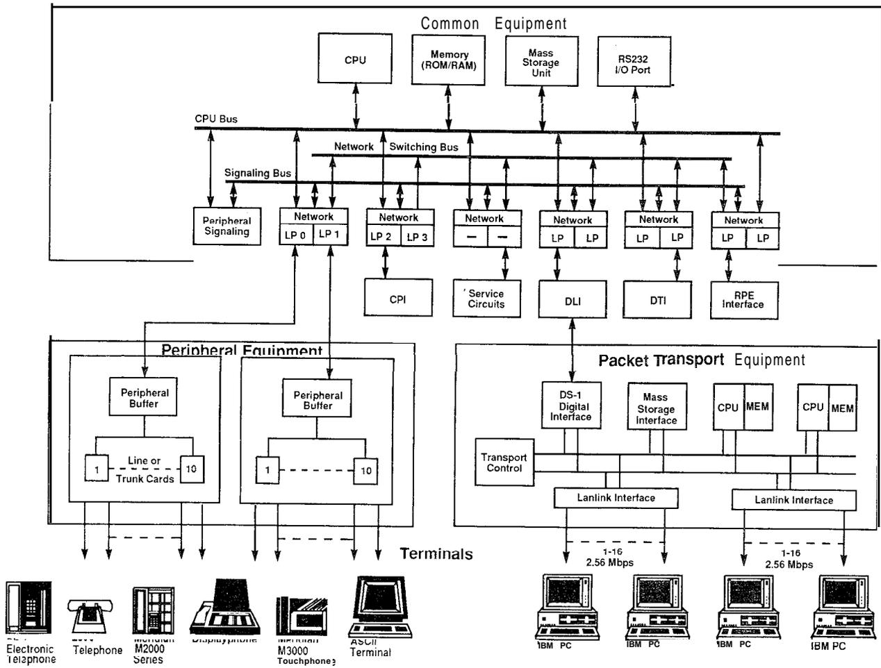
FIGURE 3-16: MERIDIAN SL-1 SYSTEM ARCHITECTURE
