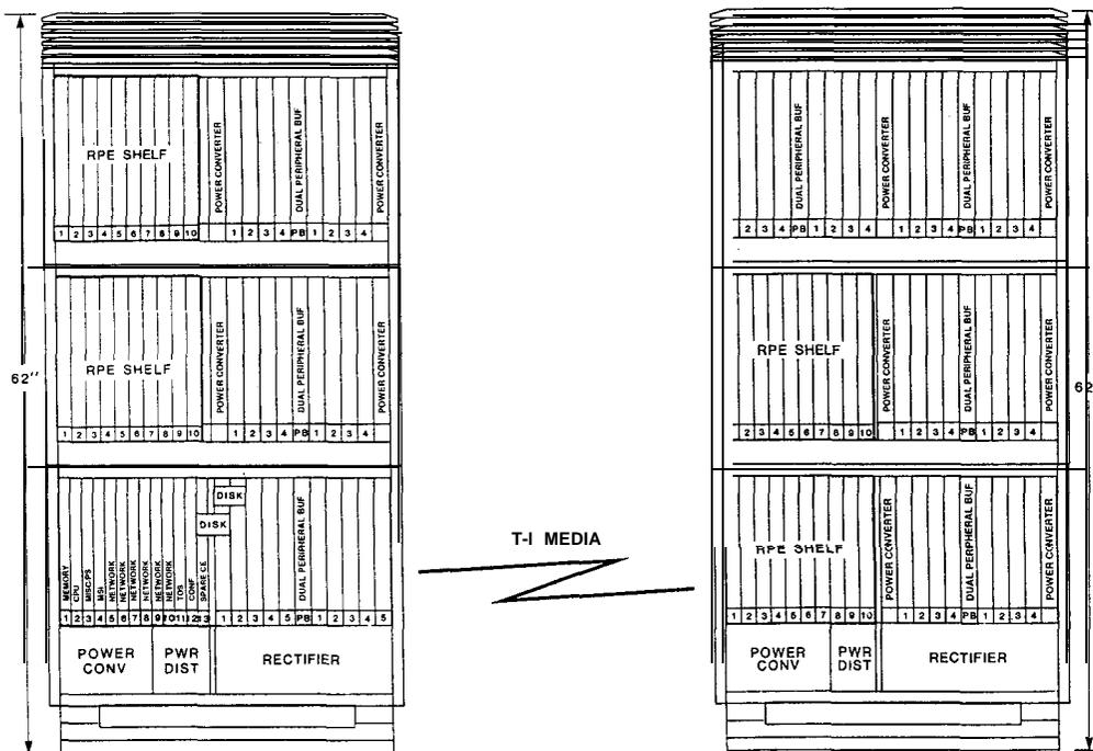
FIGURE 5-47: MERIDIAN SL-1ST TYPICAL RPE CONFIGURATION
