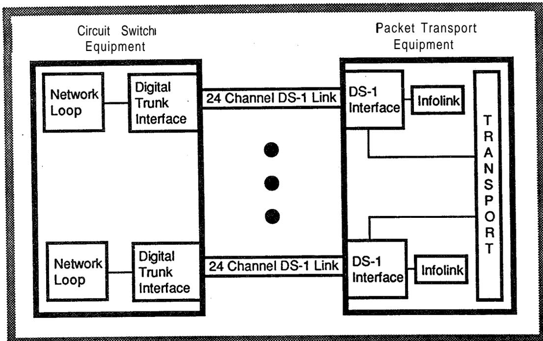
FIGURE 3-25: TYPICAL DS-1 LINK CONFIGURATION
